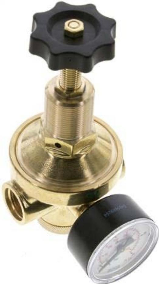
PEWO-PRESSURE-REGULATOR Durchfluss: 1000 l/min Ausführung: automatische Entlüftung bei Überdruck auf der Sekundärseite, Werkstoffe: Zink Druckguss / Dichtungen: NBR, Druckregelbereich [bar]: 0,1 - 3, Eingangsdruck [bar]: max. 16, Temperaturbereich:-10°C bis +60°C Medien: Druckluft, neutrale Gase Manometeranschluss:G  $\frac{1}{4}$ “, Gewinde: G  $\frac{3}{8}$ “, TARIC: 84811099, Ursprungsland: EEC / EU, Gewicht/Stück (kg): 0,5
