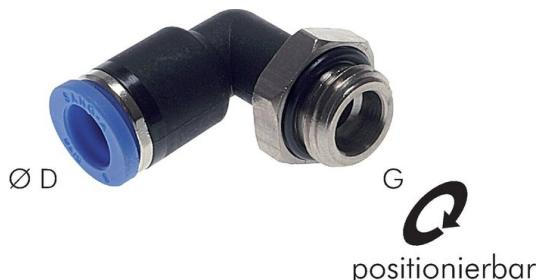
PEWOPUSH-IN Bogen 90° R 1/8"-4mm, PA kurze Länge, Gehäuse: Messing vernickelt / PA 66, Hülse: PA 66, Dichtung: NBR, Halteklaue: Edelstahl, Kartusche: verzinktes ZnDC (bei der Montage werden nur silikonfreie Dichtungen und Schmiermittel verwendet) Temperaturbereich: -20°C to +80°C Betriebsdruck: -0,95 to 20 bar PTFE-beschichtetes Gewinde TARiC-Code = 7412200000 Ursprungsland = Republik Korea / Gewicht = 0,0069 kg
