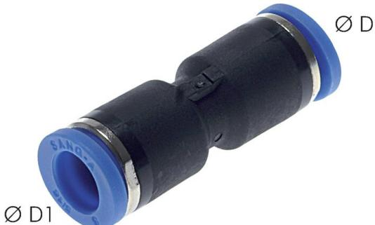
PEWOPUSH-IN Reduzier Kupplung 8mm-6mm, PA, Gehäuse: Messing vernickelt/ PA 66, Hülse: PA 66, Dichtung: NBR, Halteklaue: Edelstahl, Kartusche: verzinktes ZnDC (bei der Montage werden nur silikonfreie Dichtungen und Schmiermittel verwendet) Temperaturbereich: -20°C to +80°C Betriebsdruck: -0,95 to 20 bar TARiC-Code = 39174000990 Ursprungsland = Republik Korea / Gewicht = 0,0059 kg
