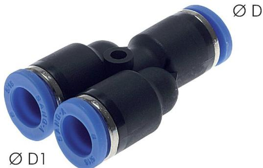
PEWOPUSH-IN Y fitting 4mm-4mm, PA, Gehäuse: Messing vernickelt/ PA 66, Hülse: PA 66, Dichtung: NBR, Halteklaue: Edelstahl, Kartusche: verzinktes ZnDC (bei der Montage werden nur silikonfreie Dichtungen und Schmiermittel verwendet) Temperaturbereich: -20°C to +80°C Betriebsdruck: -0,95 to 20 bar TARiC-Code = 39174000990 Ursprungsland = Republik Korea / Gewicht = 0,0049 kg
