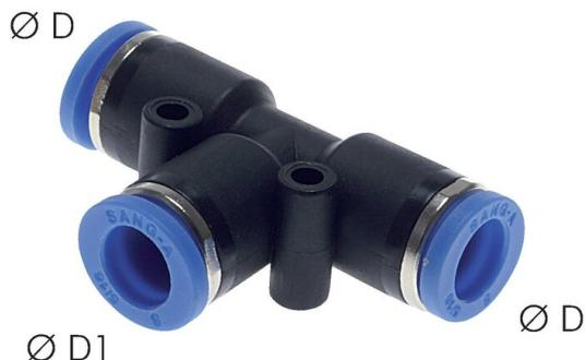
PEWOPUSH-IN T fitting 4mm-4mm, PA, Gehäuse: Messing vernickelt/ PA 66, Hülse: PA 66, Dichtung: NBR, Halteklaue: Edelstahl, Kartusche: verzinktes ZnDC (bei der Montage werden nur silikonfreie Dichtungen und Schmiermittel verwendet) Temperaturbereich: -20°C to +80°C Betriebsdruck: -0,95 to 20 bar TARiC-Code = 39174000990 Ursprungsland = Republik Korea / Gewicht = 0,005 kg
