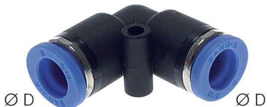
PEWOPUSH-IN Bogen 90° 4mm, PA, Gehäuse: Messing vernickelt/ PA 66, Hülse: PA 66, Dichtung: NBR, Halteklaue: Edelstahl, Kartusche: verzinktes ZnDC (bei der Montage werden nur silikonfreie Dichtungen und Schmiermittel verwendet) Temperaturbereich: -20°C to +80°C Betriebsdruck: -0,95 to 20 bar TARiC-Code = 39174000990 Ursprungsland = Republik Korea / Gewicht = 0,0034 kg
