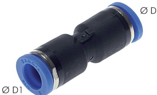
PEWOPUSH-IN gerade Kupplung 6mm-6mm, PA, Gehäuse: Messing vernickelt/PA 66, Hülse: PA 66, Dichtung: NBR, Halteklaue: Edelstahl, Kartusche: verzinktes ZnDC (bei der Montage werden nur silikonfreie Dichtungen und Schmiermittel verwendet) Temperaturbereich: -20°C to +80°C Betriebsdruck: -0,95 to 20 bar TARiC-Code = 39174000990 Ursprungsland = Republik Korea / Gewicht = 0,0043 kg
