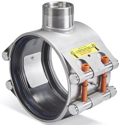
PEWOREP PN 10 NICHT ZUGFEST mit Abgang 2" Innengewinde EPDM Dichtung -30°C bis +80°C in A4 (316/1.4571) Qualität Ø min./max. 210-223 mm Breite 142 mm 2 Verschlüsse Ursprungsland: EU Zolltarifnr.: 73072980
