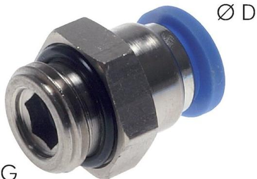
PEWOPUSH-IN gerader Einschraubfitting G 1/8"-4mm, PA mittlere Länge, Körper: Messing vernickelt / PA 66, Hülse: PA 66, Dichtung: NBR, Halteklaue: Edelstahl, Kartusche: verzinktes ZnDC (bei der Montage werden nur silikonfreie Dichtungen und Schmiermittel verwendet) Temperaturbereich: -20°C to +80°C Betriebsdruck: -0,95 to 20 bar TARiC-Code = 74122000000 Ursprungsland = Republik Korea / Gewicht = 0,0081 kg
