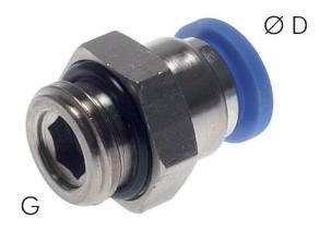
Körper: Messing vernickelt / PA 66, Hülse: PA 66, Dichtung: NBR, Halteklauen: Edelstahl, Kartusche: verzinktes ZnDC (bei der Montage werden nur silikonfreie Dichtungen und Schmiermittel verwendet) Temperaturbereich: -20°C to +80°C Betriebsdruck: -0,95 to 20 bar TARiC-Code = 74122000000 Ursprungsland = Republik Korea / Gewicht = 0,0081 kg
