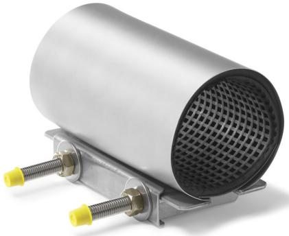
PEWOCLAMP ERS Ersatzteil A Reparatursschelle mit vier Verschlusschrauben pro Verschluss, Druckstufe: PN 16-2 Breite: 400 mm Ø min./max.: 91-98 Edelstahlqualität: Verschluss und Band A4 (1.4571) max. 300 mm Beschädigungslänge Waffelstruktur Dichtung in EPDM schwefel vernetzt Temperaturbereich: -30°C bis +60°C Ursprungsland: EU Zolltarifnr.: 73072980
