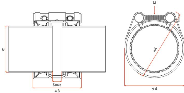
gereinigte und einzeln in Kunststoffbeutel verpackte Rohrkupplung PEWOG RIP PN 25 ZUGFEST mit EPDM Dichtung -30°C bis +125°C in A4 (316/1.4571) Qualität Ø min./max. 39-43 mm Breite 60 mm 1 Verschluss
